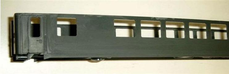
Nachdem wird das Gehäuseteil grundiert mit kunststoff primer, später lackiert in dem richtigen Endanstrich, beschriftet und mit Klarschicht übersprüht. (Siehe weiter bei Farbanstrich)
